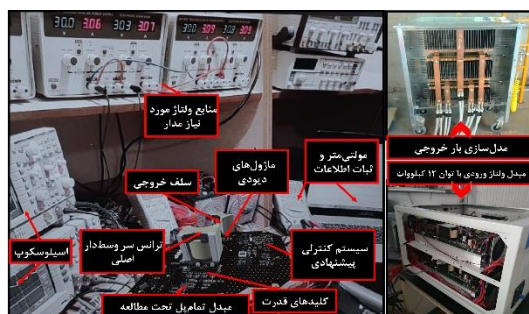
شکل (۱۳): نمونه آزمایشگاهی از روش کنترلی پیشنهادی بر روی یک مبدل DC-DC تمام‌پل ۱۲ کیلووات
