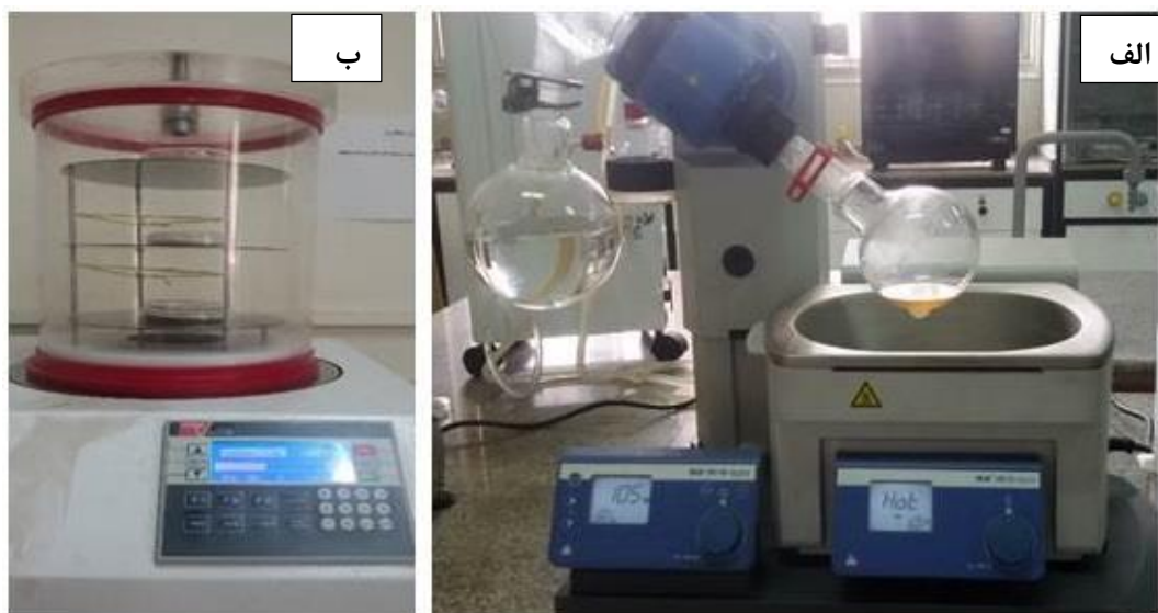
شکل ۱- بایوسورفکتانت استخراج شده به صورت مایع در دستگاه تبخیر کننده در خلأ (الف)؛ خشک کردن بایوسورفکتانت در دستگاه فریز درایر (ب).
