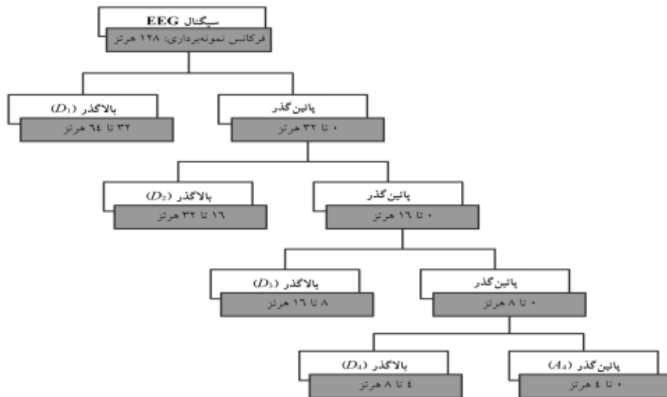
شکل ۳: سطوح مختلف تجزیه DWT توسط پالایه پایین گذر و پالایه بالاگذر D_1, D_2, D_3, D_4 و A_4 مربوط به دلتا، بتا، آلفا، بتا و گاما با فرکانس نمونه برداری ۱۲۸ هرتز
