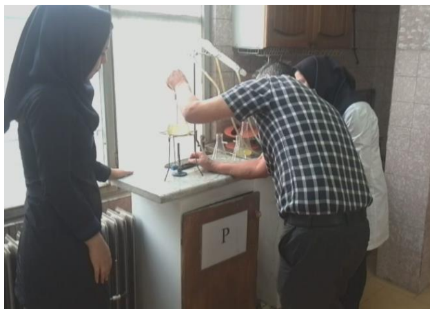
شکل ۸: آزمایش کننده هنگام تقطیر مایع به دست آمده از تخمیر مواد تخمیری و رسیدن به الکحل.
