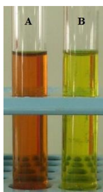
شکل ۶- نتیجه سنجش فعالیت آنزیم با معرف DNS بعد از رسوب‌دهی با آمونیوم سولفات ۷۵ درصد و دیالیز. (B- بلانک، A- نمونه بعد از دیالیز)
