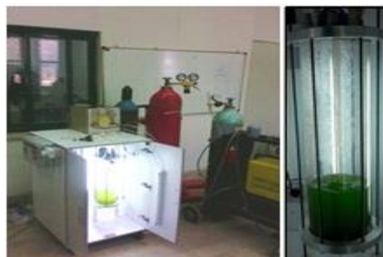
شکل ۱- کشت ریزجلبک در فتوبیوراکتور
