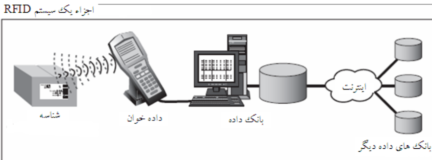
شکل ۳: اجزای یک سیستم RFID (منبع: اداره حسابرسی دولتی آمریکا)
