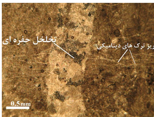
شکل ۳- تصویر میکروسکوپی از سنگ آهک اکباتان در نور xpl
