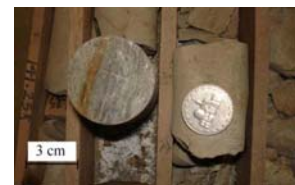
شکل ۴- ساخت لایه‌ای در مقیاس متوسط لایه، لایه‌های متناوب سولفیدی و سنگ همبر شیست (سرسیت- کارینوشیست)، سولفیدهای اولیه پس از تشکیل همزمان با سنگ همبر بر اثر هوزردگی اکسید شده‌اند.
