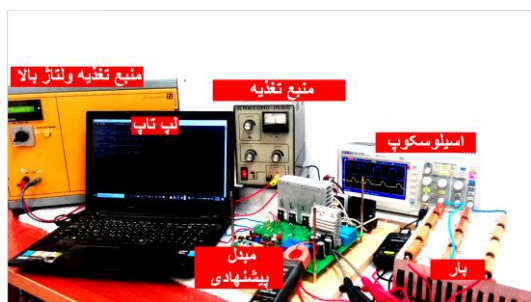
شکل (۱۳): سیستم آزمایشگاهی اجراشده شارژر پیشنهادی
