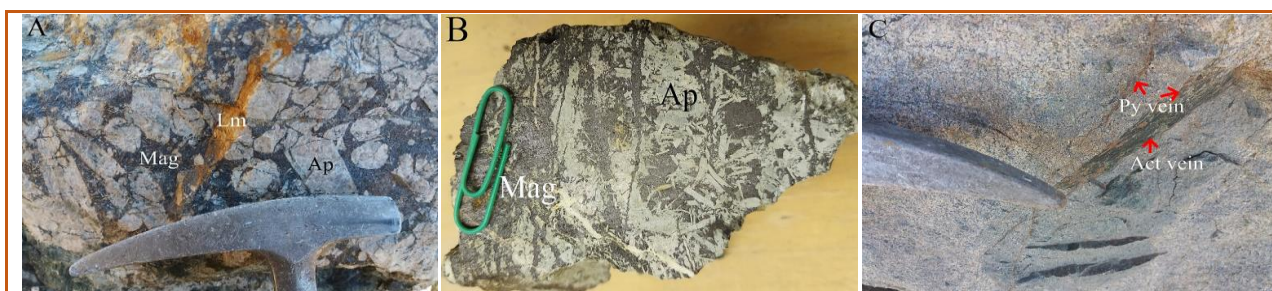
شکل ۱۵. A) بلورهای درشت آپاتیت در زمینه مگنتیت؛ B) تصویر نمونه دستی از قطع‌شدگی کانه‌زایی مگنتیت-آپاتیت توسط رگچه‌های مگنتیت، C) رگچه‌های نازک پیریت و رگچه اکتینولیتی در سنگ‌های گرانیتویدی.
