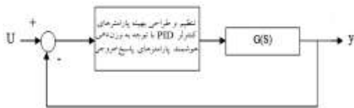
شکل (۱): بلوک دیاگرام کنترلر PID با استفاده از الگوریتم ازدحام ذرات و نلدردیم (PSO-NM)
